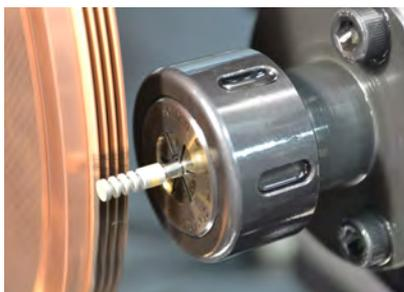
微小径砥石への溝加工
