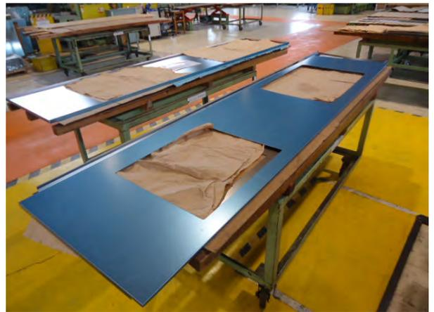
最新モデル4mベンダー機により折り曲げ加工した製品
