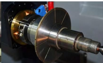
側面への溝加工
