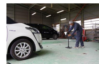
一つであり、顧客の安心感にもつながっている。美寄車体では、他にもイタリア製のフレーム修正機『グローバルジグ』を導入。事故などで損傷が出た自動車のフレームの歪みを1mm単位で修正できるようになった。また、自動車にセンサー機能が次々と搭載される中、その調整に不可欠な『レーダーエーミングツール』なども導入した。
