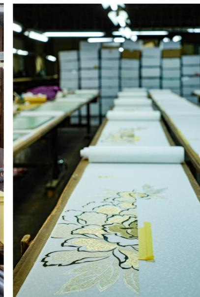
型染めが基本。時間もコストもかかってしまっていた。そこで、平成30年にインクジェットプリンターを導入。型染めだと2-3ヶ月かかる染色が1ヶ月程度に、コストも1/5ほど抑えることができた。しかし、新しい機械を使った染色では、蒸し工程で問題が発覚。既存の蒸し機では発色が弱く、水滴で色落ちてしまうため、売り物にすらならない状態だった。
