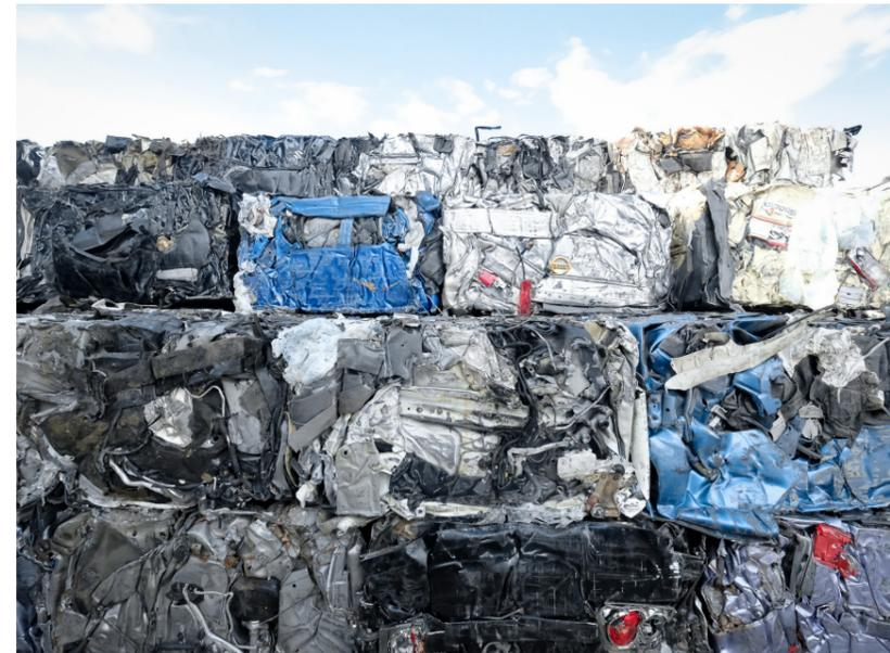
数%。その理由はプレス中の銅の含有量を抑えることが難しいからだ。銅の含有量が多いと製鋼品質の低下につながるのだが、この作業は工程数が多く、コストもかかる。それでも飛田テックは環境負荷の観点から「全部再資源化」に取り組んでいる。常に全国トップクラスの納入量を誇り、新潟県内で約半数近くを処理。しかし、既存設備では生産性の向上が見込めず頭打ちとなっていた。
