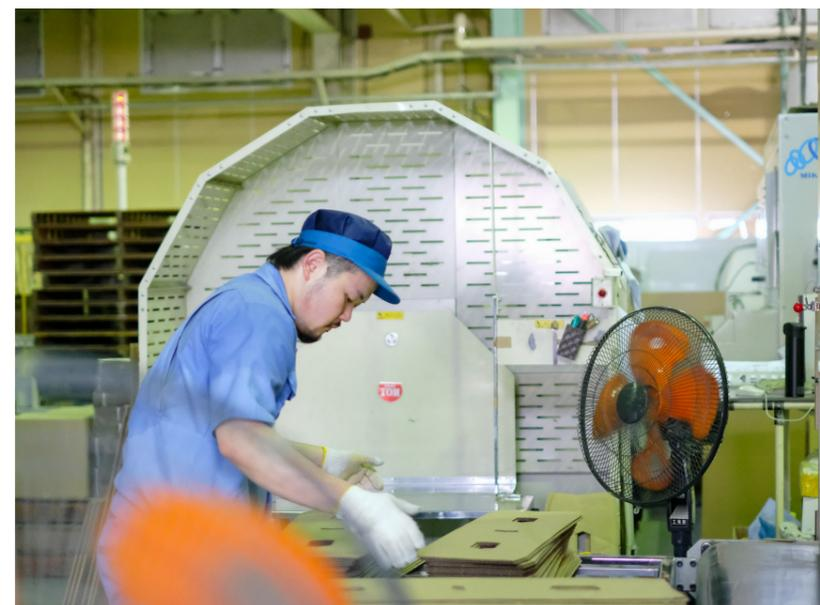
まで加工できる大型の製造機を導入し、縦型の花用段ボールなど大型製品の複雑形状加工も可能となった。しかし、大型製品は材料も大きく、重量もある。給紙作業を人力で行っていたため、加工機械の生産可能数を下回る量しか加工ができず、効率化のボトルネックになっていた。
